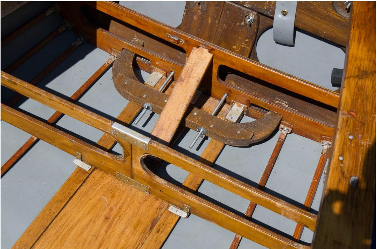
Restliche Spanten einsetzen und danach mit u-förmigem Spannteil über die Flügelmuttern den Boden in Längsrichtung spannen
