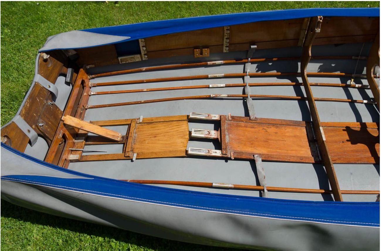
Inneres Heckteil einsetzen und mit leichtem Druck Boden und Bordwandteile ineinander setzen
