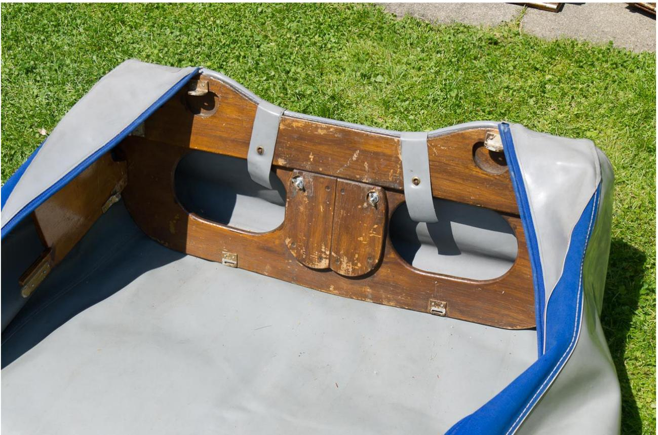
Heckspiegel einsetzen: 2 Laschen in Schrauben einhängen, Haut von oben in Nut einfädeln, „Flügel“ des Heckspiegels unter Bootshaut legen
