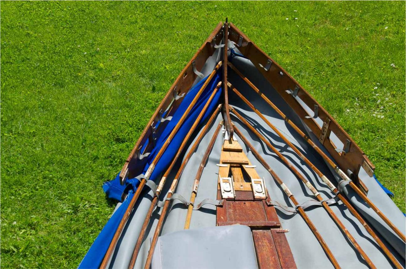
Boden und Längsspannen verbinden
