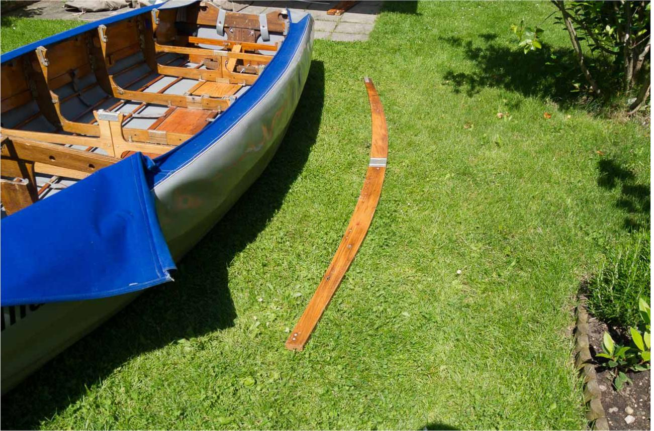
Reling in zwei Teilen (Vierkantlöcher hinten) von vorn und hinten auf Verdeck aufschieben und mit Haken an den Spanten sichern
