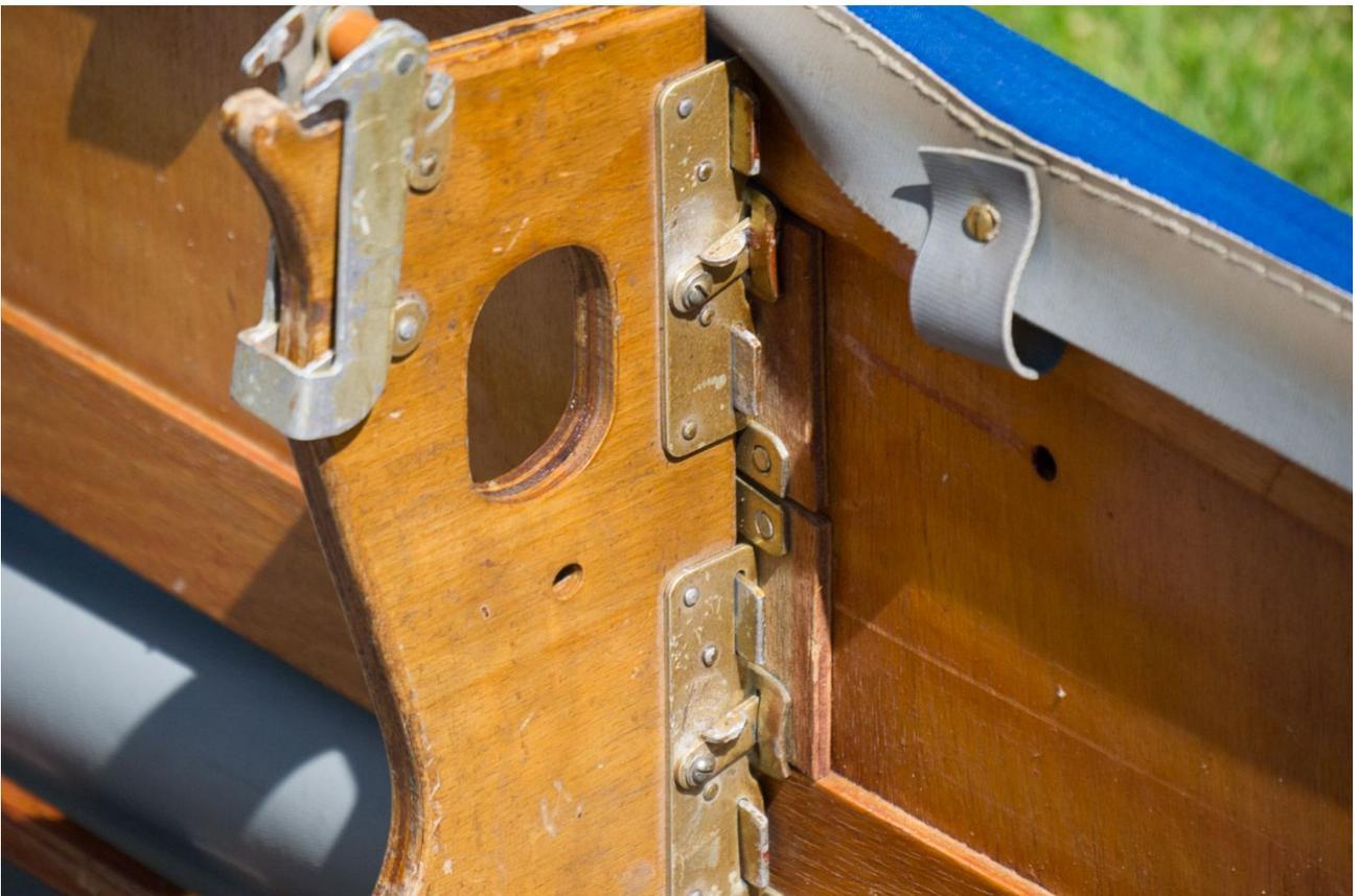
Bordwände und Querspannen einsetzen bis zum mittleren Scharnier, Querspannen mit kleinen Häkchen sichern
