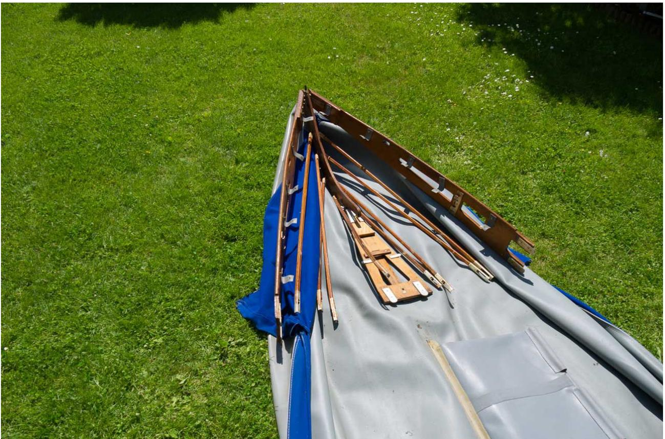
Bugteil montieren (Schraube im Kiel)
