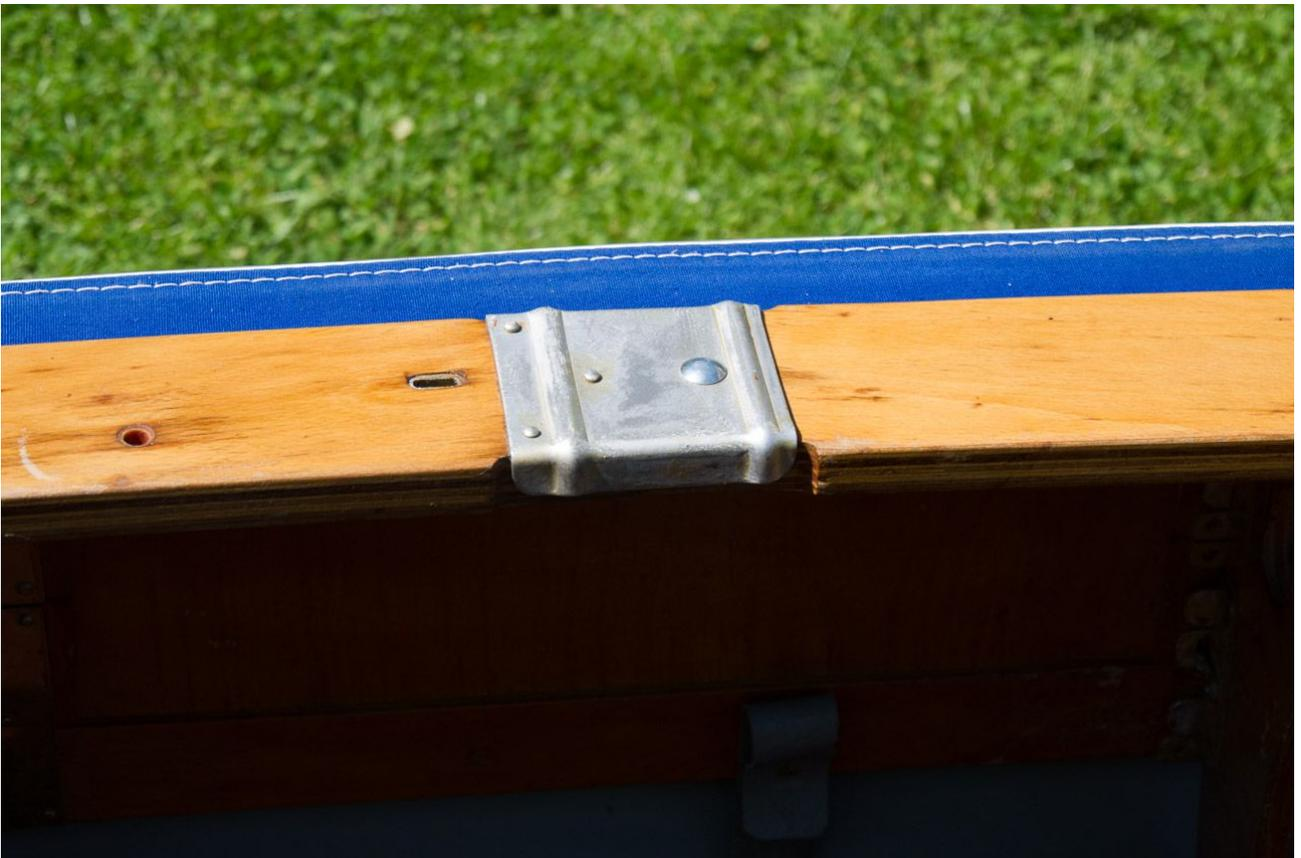
Relingteile verbinden (Kurze Schraube)
